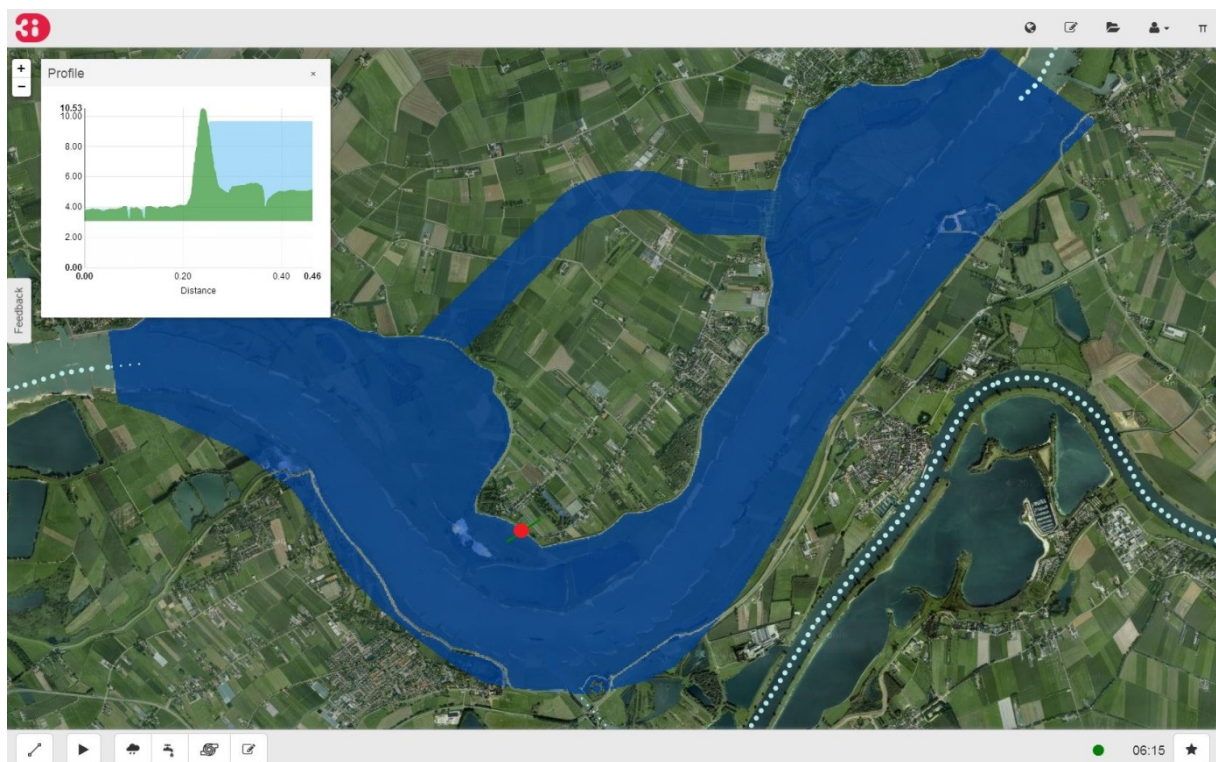
Figuur 13 Bypass levert een waterstandsverlaging op van 0.5 m+NAP gesimuleerd met 3Di.
