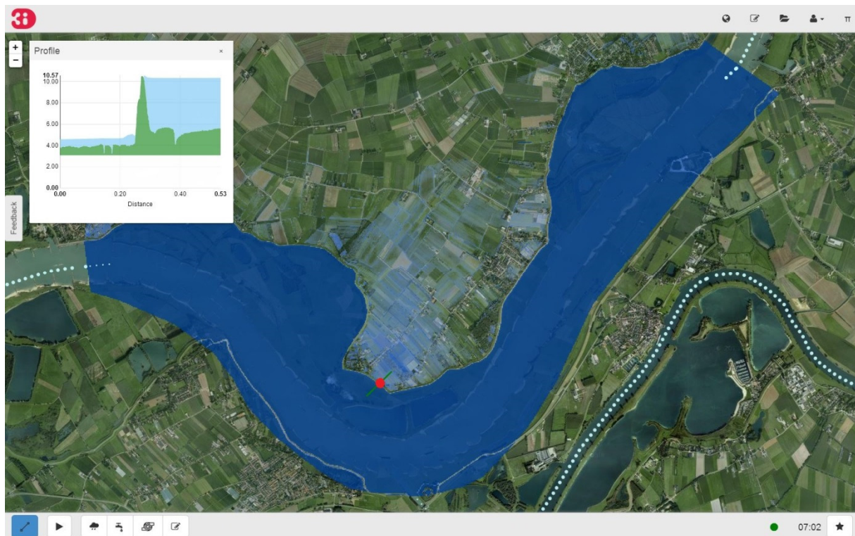
Figuur 11 Overstroming van de dijk (rode cirkel) bij een waterstand van 10.4 m+NAP gesimuleerd met 3Di
